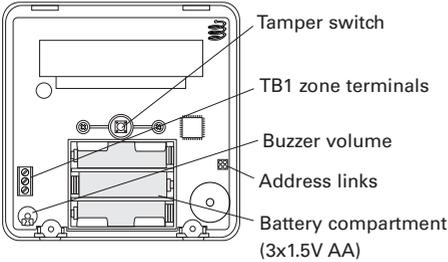
Figure 6. Keypad PCB
