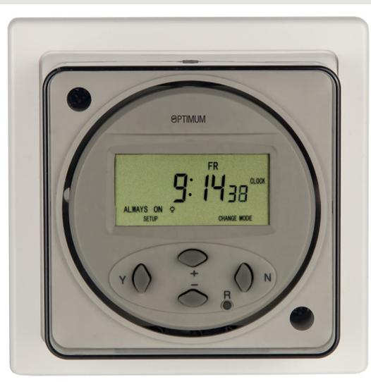
OP-SBDIGI IS A DIGITAL 24-HOUR / 7 DAY TIME SWITCH. MINIMUM SWITCHING TIME 1 MINUTE. THE TIMER IS SUITABLE FOR INSTANTLATION ON A SURFACE OR IN-WALL PAT-TRESS BOX. THE TIMER CONTROLS A VOLT-FREE CHANGEOVER SWITCH, WITH A RESISTIVE RATING OF 16 AMPERES.
